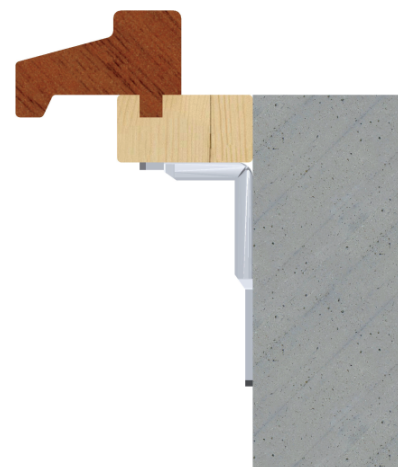
Detail 3: Verankering stelkozijnen.
