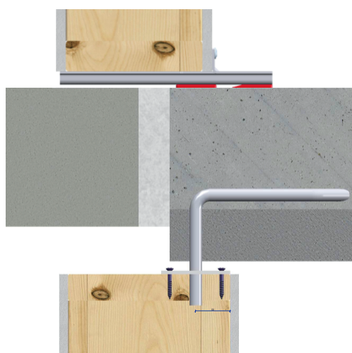
Detail 3: Bevestiging HSB-wanden met BS-anker in de breedplaatvloer met kleine randafstand in het hout.
