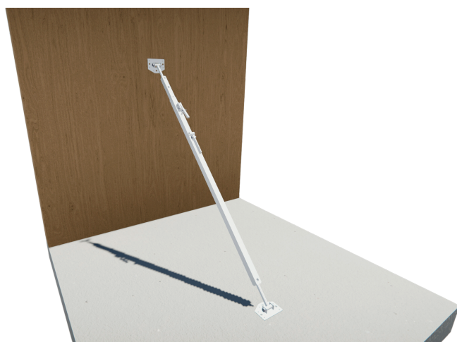
Detail 1: Toepassing verstelbare schoor op de bouw.
