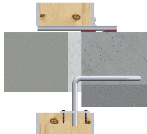
Detail 4: Bevestiging HSB-wanden met BS-anker buiten de breedplaatvloer met kleine randafstand in het hout.
