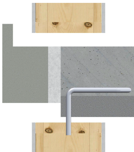
Detail 1: Bevestiging HSB-wanden met BS-anker in de breedplaatvloer
