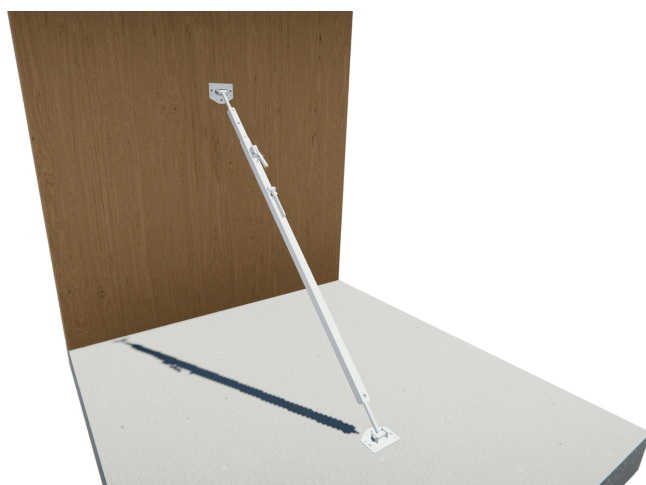
Detail 1: Toepassing verstelbare schoor op de bouw.
