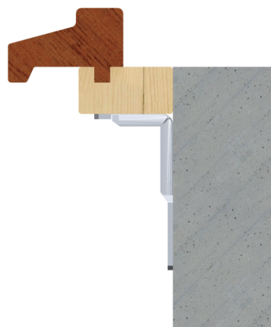
Detail 3: Verankering stelkozijnen.
