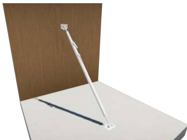
Detail 1: Toepassing verstelbare schoor op de bouw.
